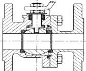
Pour modèle inox Ref. 759 DN15 au DN100 : Inox 316
